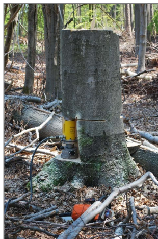
Abbildung 88: Hubkraftermittlung an einem Hochstumpf (Eigene Darstellung)
