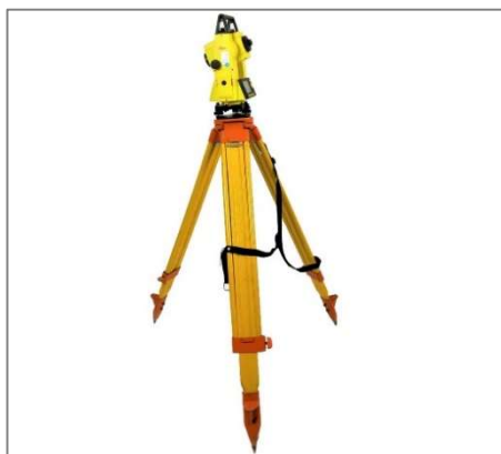
Abbildung 39: Bautachymeter zur Ermittlung der Baumgeometrie (Eigene Darstellung)
