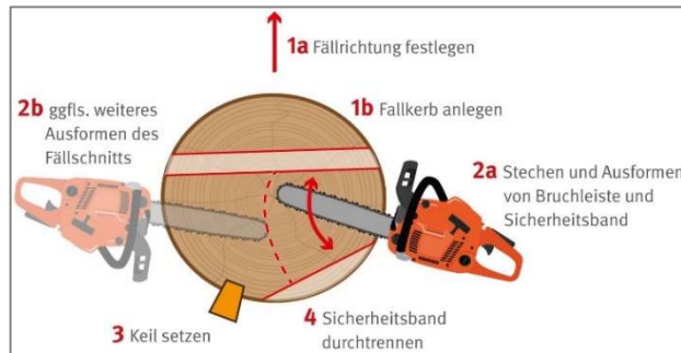
Abbildung 24: Sicherheitsfälltechnik (Deutsche Gesetzliche Unfallversicherung e.V [DGUV], 2019)
