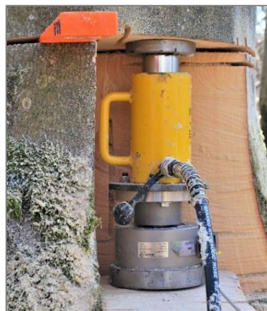
Abbildung 66: Vorbereitete Kraftmessdose und Hubzylinder (Eigene Darstellung)
